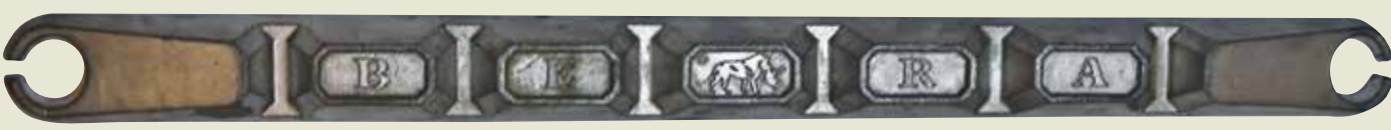
«Χελώνα» Μεταλλική ράβδος από κράμα μολύβδου, καθαίρεση και αντιμονίου για την κατασκευή στοιχείων μονοτυπίας ή ράβδων λινοτυπίας
