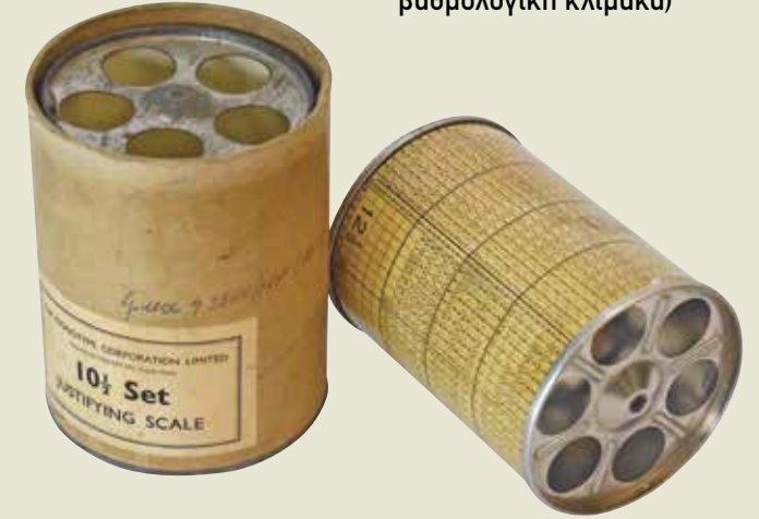
Τύμπανα μηχανής πλάκτρων μονοτυπίας (με ρυθμιστική βαθμολογική κλίμακα)
