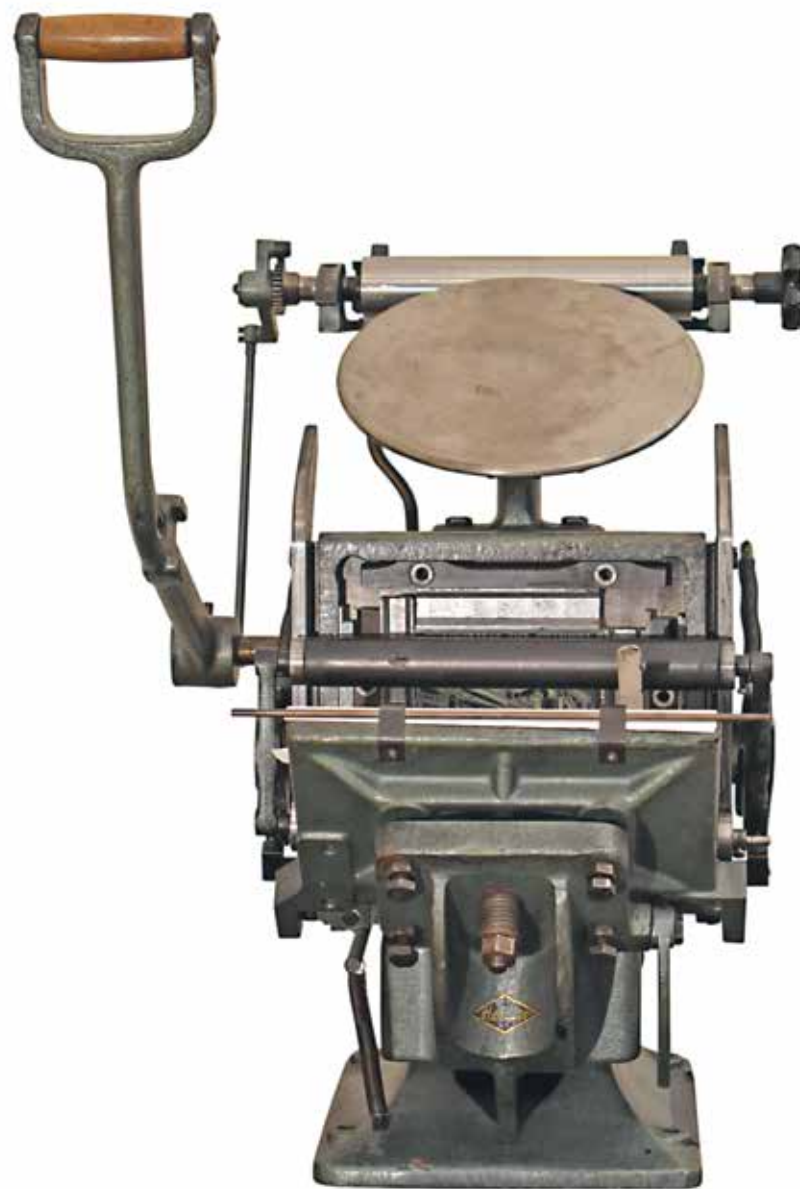
Όρθιο χειροκίνητο πιεστήριο τύπου Boston, Μοντέλο Hohner Hobo II, Εταιρεία κατασκευής: Hohner Maschinenbau GmbH, Tuttlingen, Γερμανία, μέσα της δεκαετίας του 1930.
